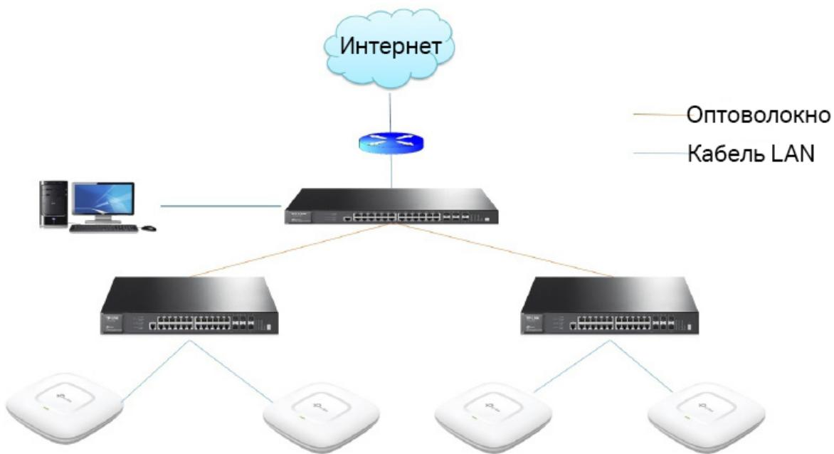
EAP245 работает на стандарте Wi-Fi 802.11ac и поддерживает технологию 3×3 MIMO. Скорость на диапазоне 5 ГГц составляет до 1300 Мбит/с, а на 2,4 ГГц — до 450 Мбит/с.
